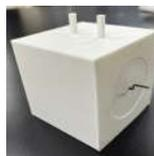
仕組み: 形状記憶合金を内部で加熱し変形させ、鍵の外枠と内部を貫いているピンを押し上げることで鍵が回るようになる。
