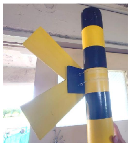
【写真 17】 警報灯のアームとクロスマーク接着
