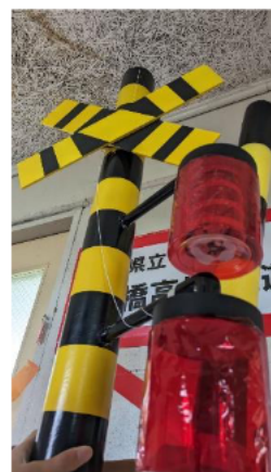
【写真 18】警報灯（左）塗装前、（右）完成後 右：上の警報灯にのみテープ LED を入れた
