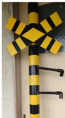
【写真 17】 警報灯のアームとクロスマーク接着
