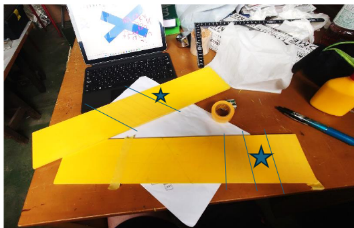
【写真3】 クロスマーク製作途中（黒 塗装前） テープが見づらいので境界線に線を付けた。
